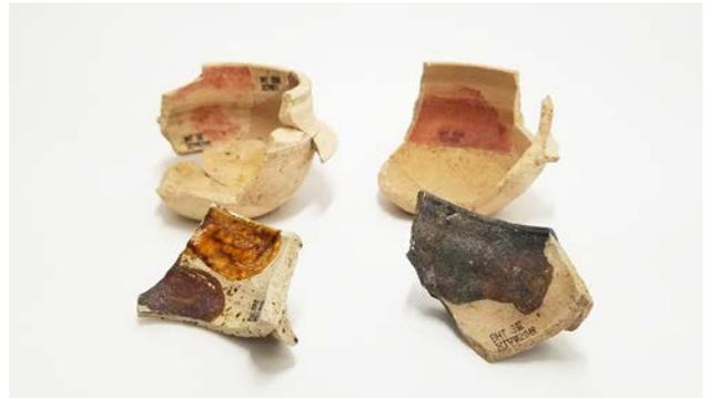
第9図 豆羽釜の破片を再利用したテストピース(鉄釉)
