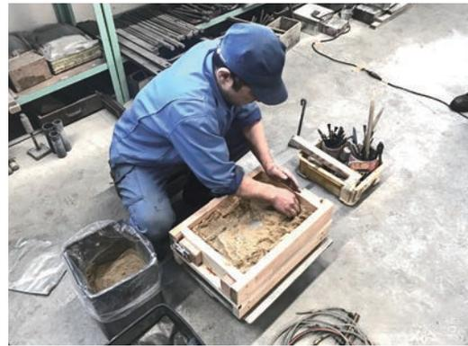
2 型枠に鑄砂を詰め込む
