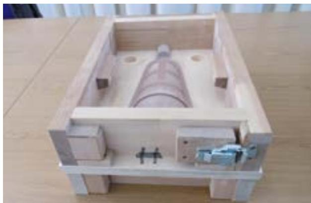
図74 鋳型の型枠（中央にあるのは銅鐸の雄型）
