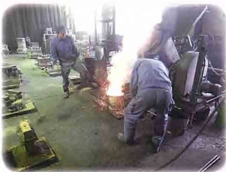
銅を溶かして流し込む （鋳造：株式会社小松製作所）
